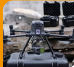
CETEMAS - LiDAR sensor
